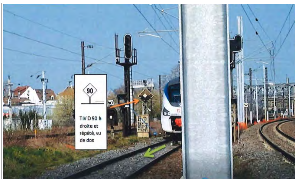
Vue 11 : vue du train arrivant. À gauche et de dos, le TIV 90 acquitté. (vue en direction opposée à Strasbourg)
