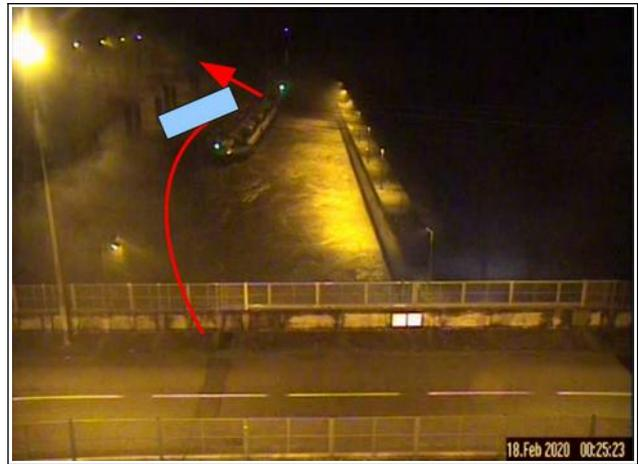
Peu après 0 h 26 min, le bateau revient en marche avant à assez vive allure, atteint l'entrée de l'écluse et percute le mur guide en rive gauche, le choc le fait pivoter, il percute le mur en rive droite et pénètre dans l'entrée de l'écluse. Les chocs entraînent des secousses au niveau du bateau et le font tanguer.
