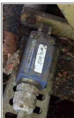
Le frein à mâchoires est commandé électriquement. Sans énergie électrique, le frein est serré.
