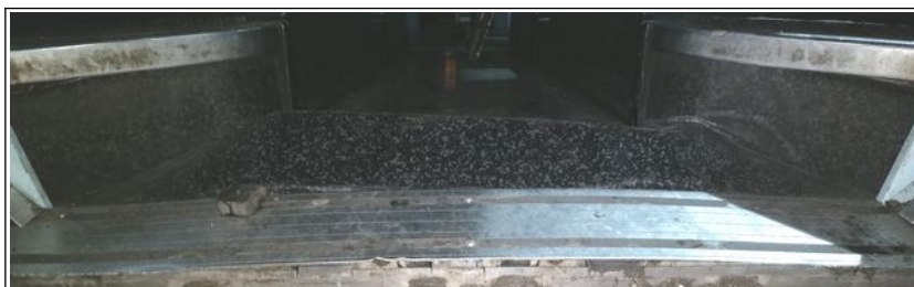
Figure 23 - Déformation du châssis au niveau de la nacelle du tramway n° 2012 (photo BEA-TT)
