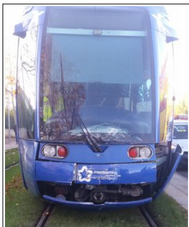
Figure 22 - Cabine du tramway percuté n° 2012 (photo TaM)
