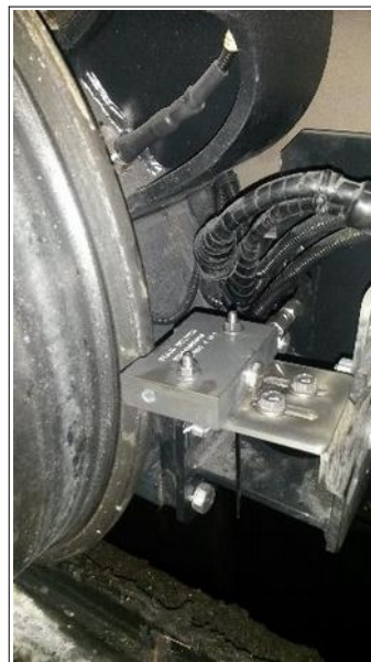
Figure 60 - Système de graissage des boudins après modification (photo TaM)
