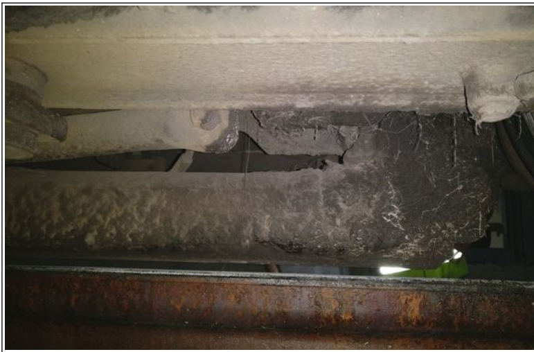
Figure 51 - Patin magnétique couvert de graisse, tramway n° 2028, septembre 2020 (photo BEA-TT)
