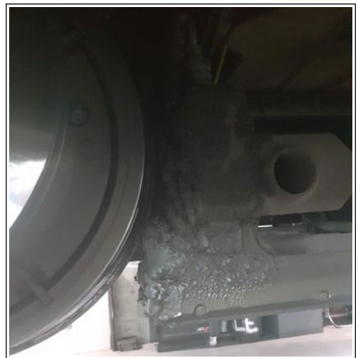
Figure 52 - Patin de rame 401 le 31 août 2021 (photo STRMTG)
