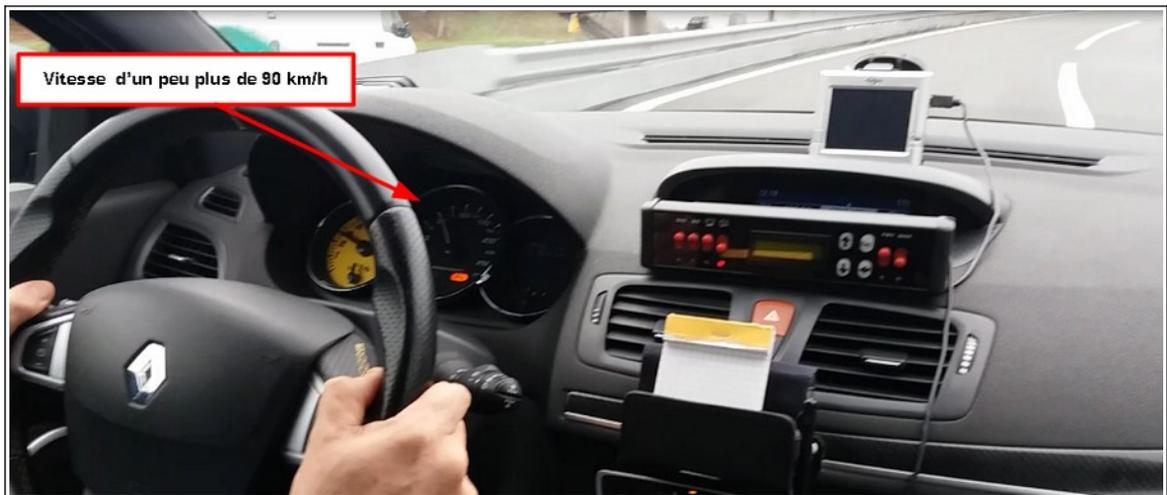
Engagé dans le début du virage, un freinage léger est réalisé qui a pour conséquence une diminution de la vitesse du véhicule à 80 km/h. Un braquage très léger à droite l'accompagne.
