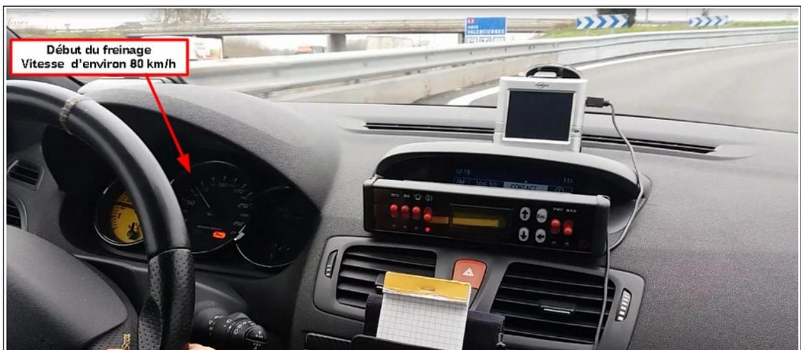
Arrivé quasiment au niveau de la première balise multichevrons, un freinage brutal est nécessaire pour éviter un sous-virage et une sortie de route. La vitesse diminue de 50 km/h en environ 2 secondes, soit une décélération moyenne de  $7 \text{ m/s}^2$ .
