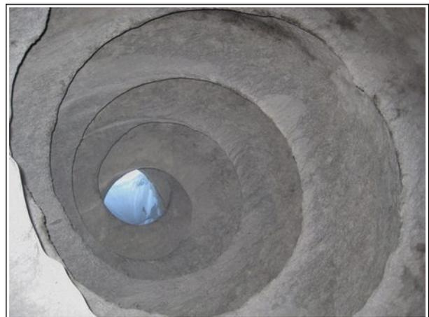
Figure 14 : sens de rotation de la toupie en circulation sur la voie publique, et intérieur d'une toupie avec double hélice hélicoïdale permettant le brassage et le déchargement du béton
