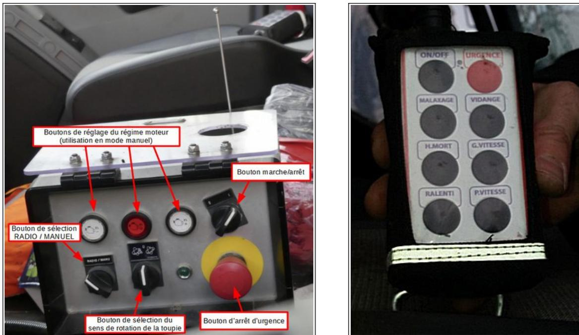
Figure 12 : boîtier de commande de la toupie en cabine (entre les deux sièges) avec sa radiocommande
