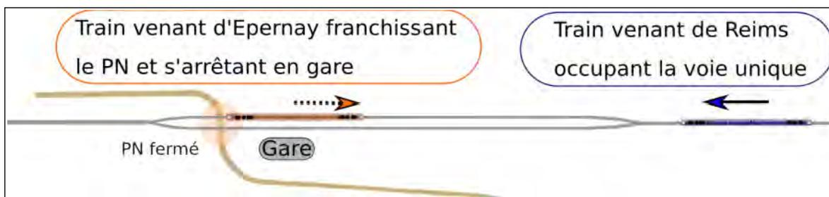
*Figure 25 : schéma illustratif de la situation 3-b avec un train en provenance d'Épernay franchissant le PN fermé, le train venant de Reims occupe la voie unique.*
