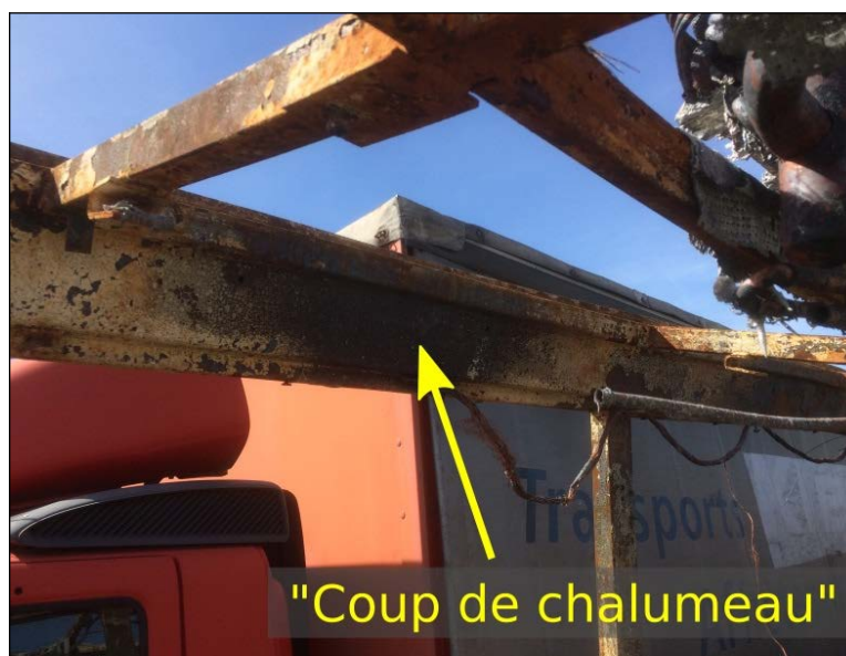
Figure 12 : Vue d'un « coup de chalumeau » sur le longeron de l'autocar incendié
