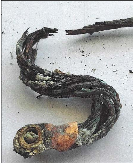
Figure 13 : Extrémité du câble d'alimentation électrique de l'unité de climatisation (à gauche) et cosse de fixation du câble (à droite)
