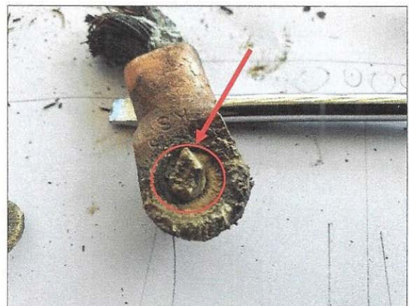
Figure 14 : Autres vues de la cosse de fixation du câble d'alimentation électrique de l'unité de climatisation
