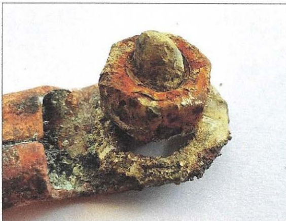
Figure 14 : Autres vues de la cosse de fixation du câble d'alimentation électrique de l'unité de climatisation
