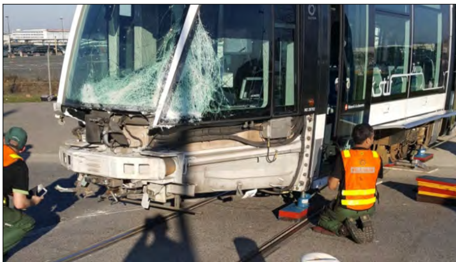
Figure 39 : Opération de remise sur les rails de la rame accidentée (source RATP)
