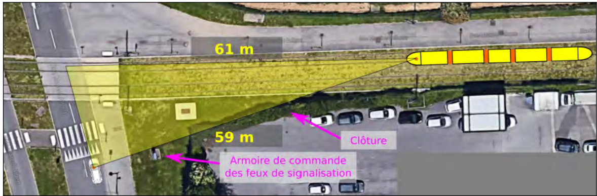
Figure 14 : Triangle de visibilité au carrefour n° 38 sur un véhicule arrêté aux feux routiers
