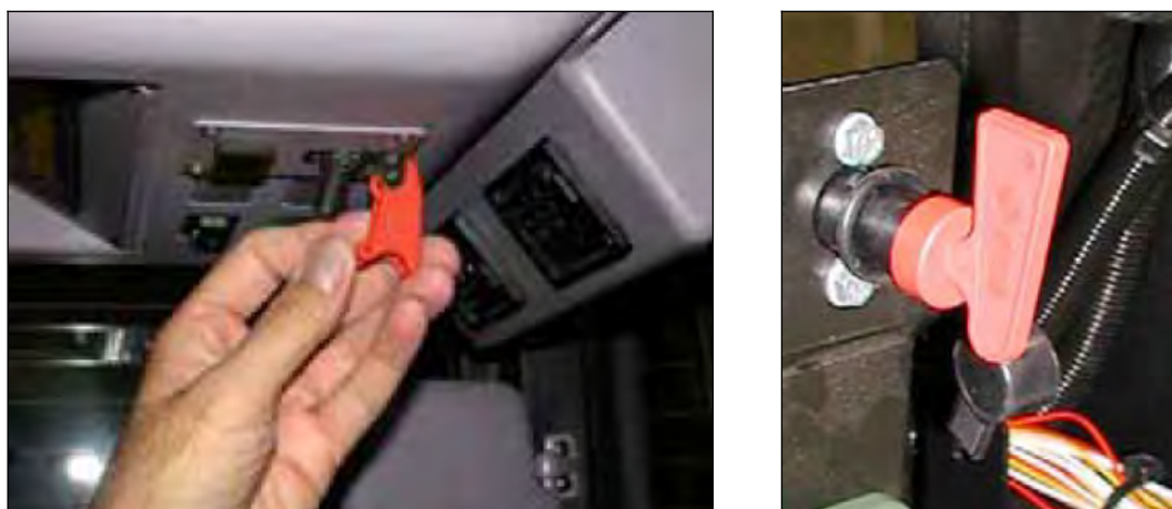
Figure 19 : Exemples de procédures d'utilisation du coupe-batterie présentées dans le guide Mercedes (source Mercedes-Benz)
