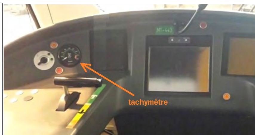
Figure 55 : vue sur le poste de conduite (tachymètre à gauche, IHM au centre)
