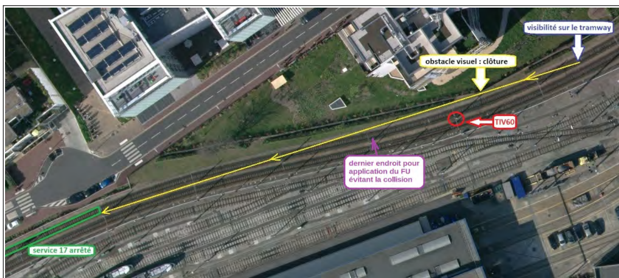
Figure 49 : emplacement du TIV60 par rapport au début de la visibilité sur le tramway arrêté en ligne et localisation du dernier endroit où le conducteur pouvait s'arrêter sans collision
