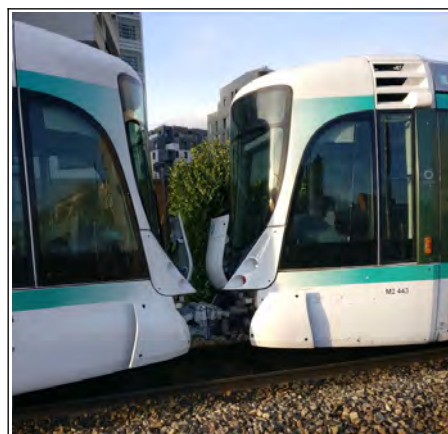
Figure 6 : attelage entre deux rames Citadis 302
