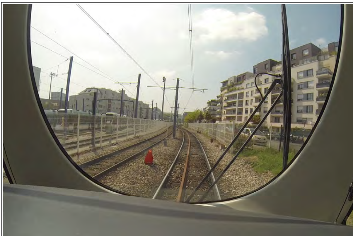
Figure 67 : localisation du tramway deux secondes avant l'impact, au moment de l'enclenchement du freinage d'urgence
