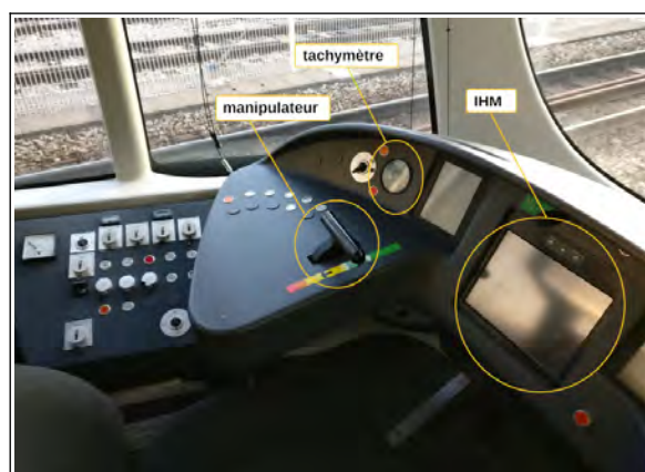
Figure 53 : partie gauche du pupitre de conduite d'un Citadis 302 de la ligne T2
