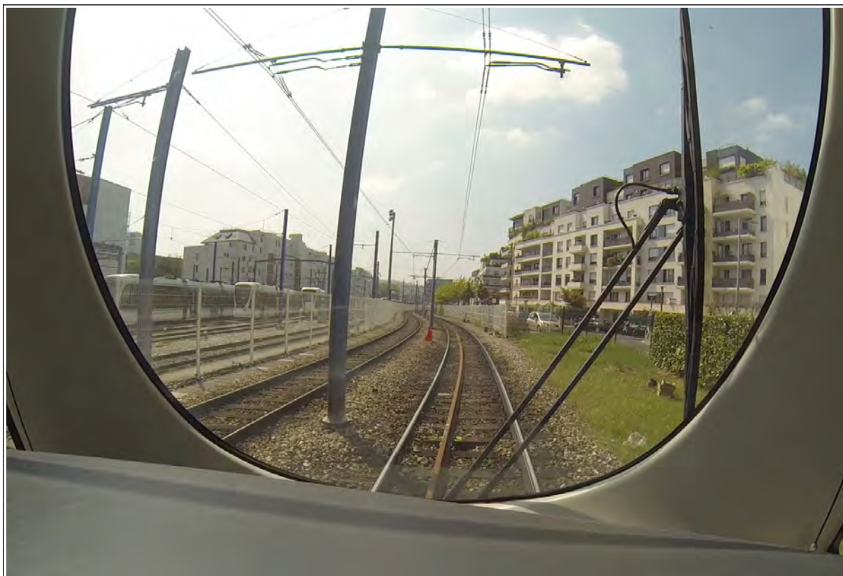
Figure 66 : localisation limite où un FU aurait permis de ne pas percuter le tramway arrêté
