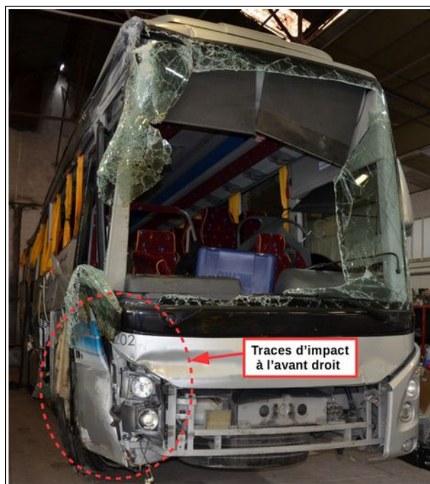
Figure 21 : Face avant de l'autocar accidenté
