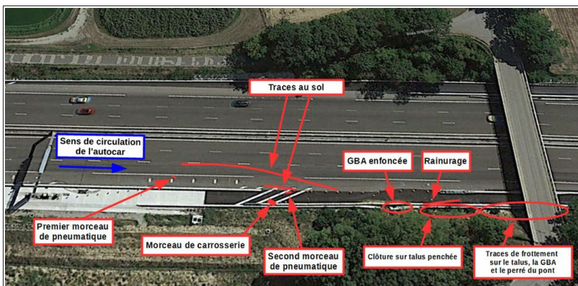
Figure 9 : Traces de l'accident sur la zone amont du pont
