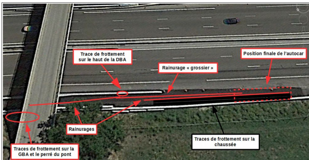
Figure 10 : Traces de l'accident sur la zone aval du pont
