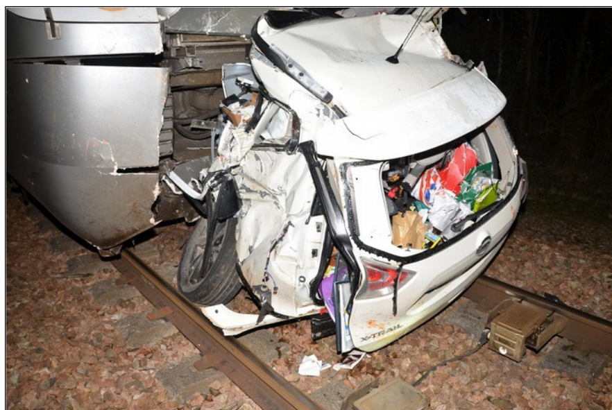
Figure 16 : Vue de la partie arrière du véhicule encastrée dans le TER
