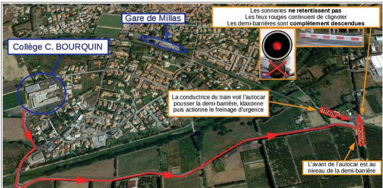
L'autocar, après avoir terminé sa giration, pousse la demi-barrière et s'engage sur le passage à niveau. La stagiaire conductrice du train s'en aperçoit et déclenche le freinage d'urgence.
