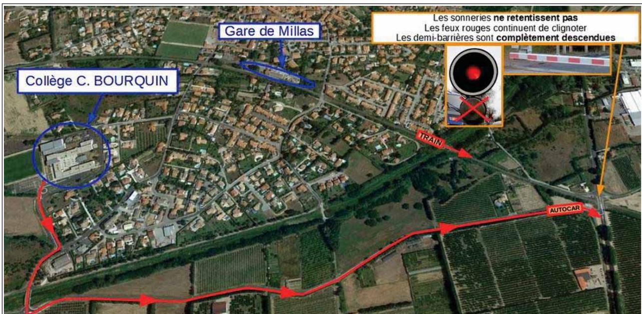
26 secondes après la détection du train par les pédales d'annonce, l'autocar arrive au niveau du cédez-le-passage alors que le train est à environ 255 m du PN à une vitesse d'environ 70 km/h.
