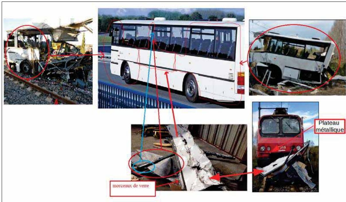
**Figure 69 : Emplacement de la bande de carrosserie du côté latéral gauche de l'autocar**
