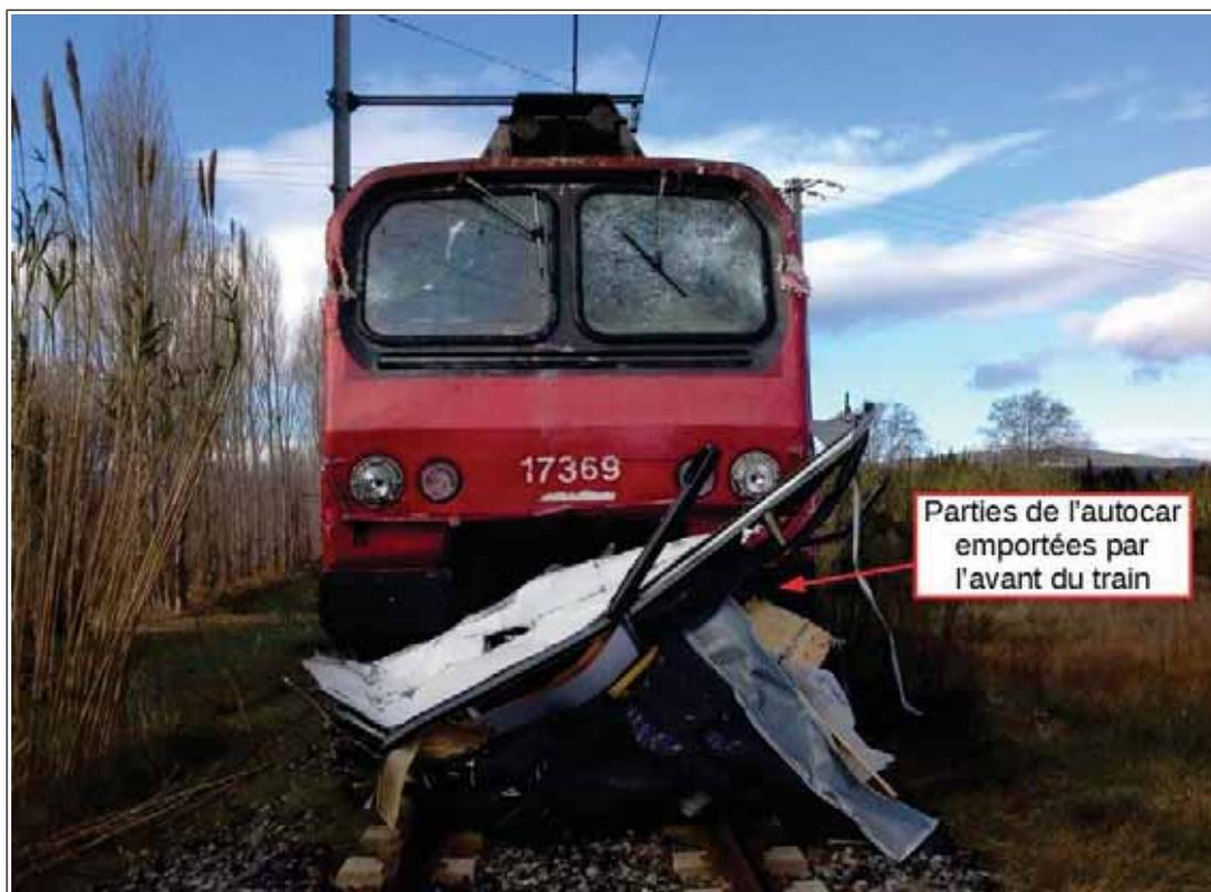
*Figure 42 : Face avant du train après l'accident*
