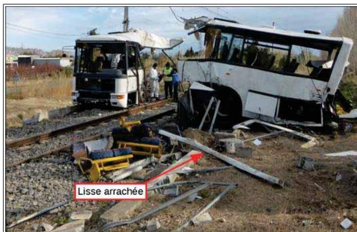
**Figure 55 : Position finale de la lisse arrachée**
