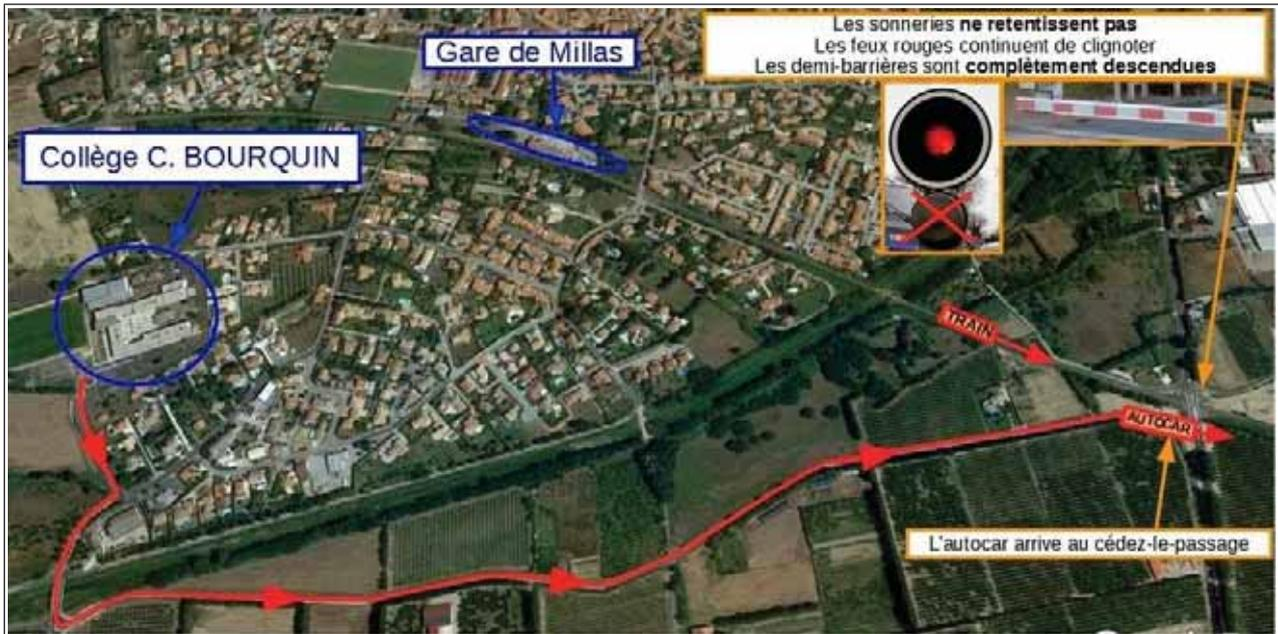
34 secondes après la détection du train par les pédales d'annonce, soit environ 4 secondes avant la collision, l'avant de l'autocar est au niveau de la demi-barrière et le train est à environ 90 m du PN25 à une vitesse d'environ 77 km/h.
