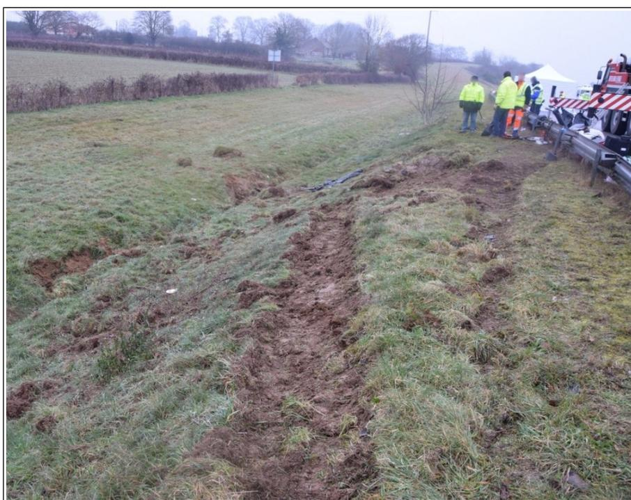
**Figure 15 : Traces de sortie de l'autocar sur le talus**
