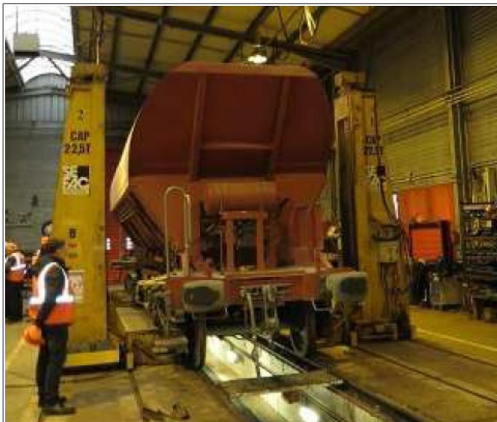
*Figure 20 : Wagon sur la voie de levage d'Hourcade*
