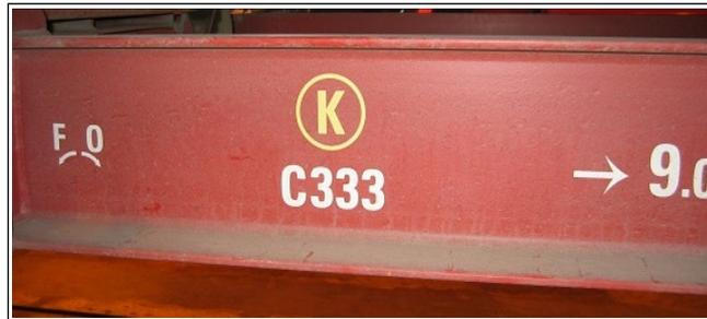
Figure 9 : Marquage du type de semelle sur le longeron du wagon
