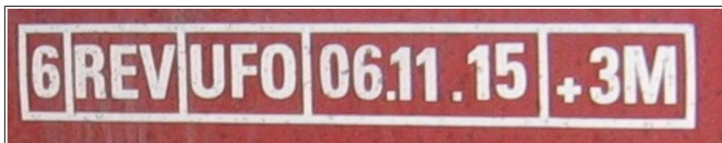
*Figure 11 : Cartouche de révision indiquant la date de sortie d'usine*
