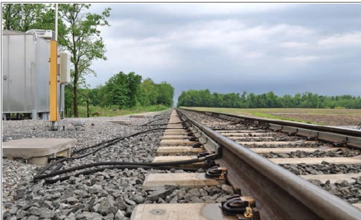
Figure 29 : Système WILD avec ses capteurs dans les rails et sa guérite.
