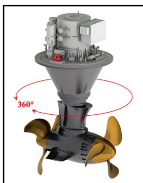
Figure 11 : Propulseurs du bateau à passagers VIKING HERMOD
