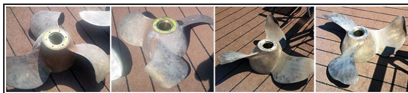
Figure 19 : Hélices des propulseurs endommagées après le talonnage
