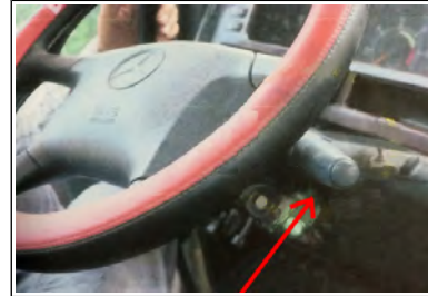
Figure 29 : Levier de commande du frein moteur au niveau du volant
