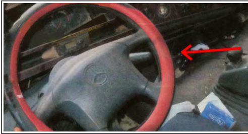
Figure 29 : Levier de commande du frein moteur au niveau du volant
