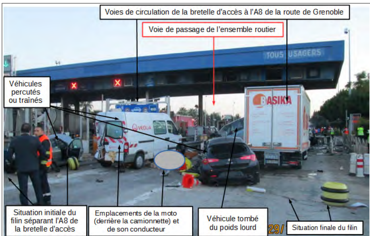
Figure 22 : Barrière de péage de Saint-Isidore, vue dans le sens de circulation des véhicules accidentés
