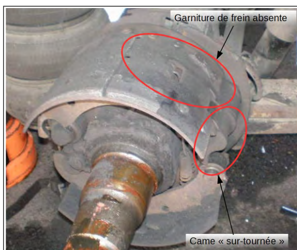
Figure 32 : Garniture de frein manquante et came en position non fonctionnelle
