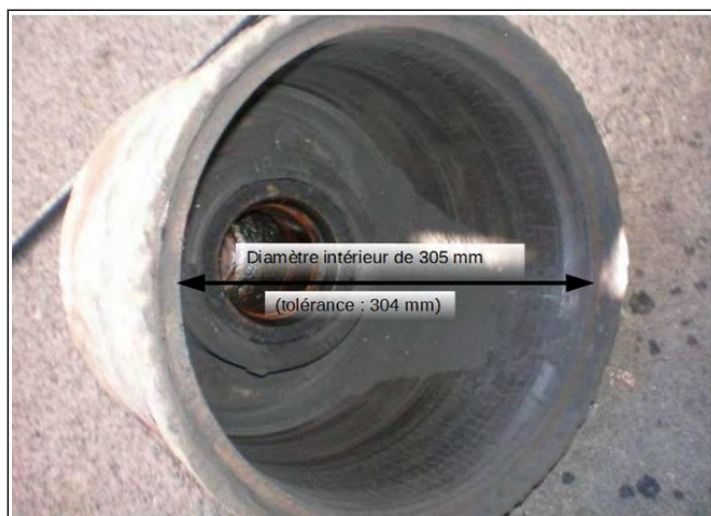
Figure 31 : Tambours de frein hors cote
