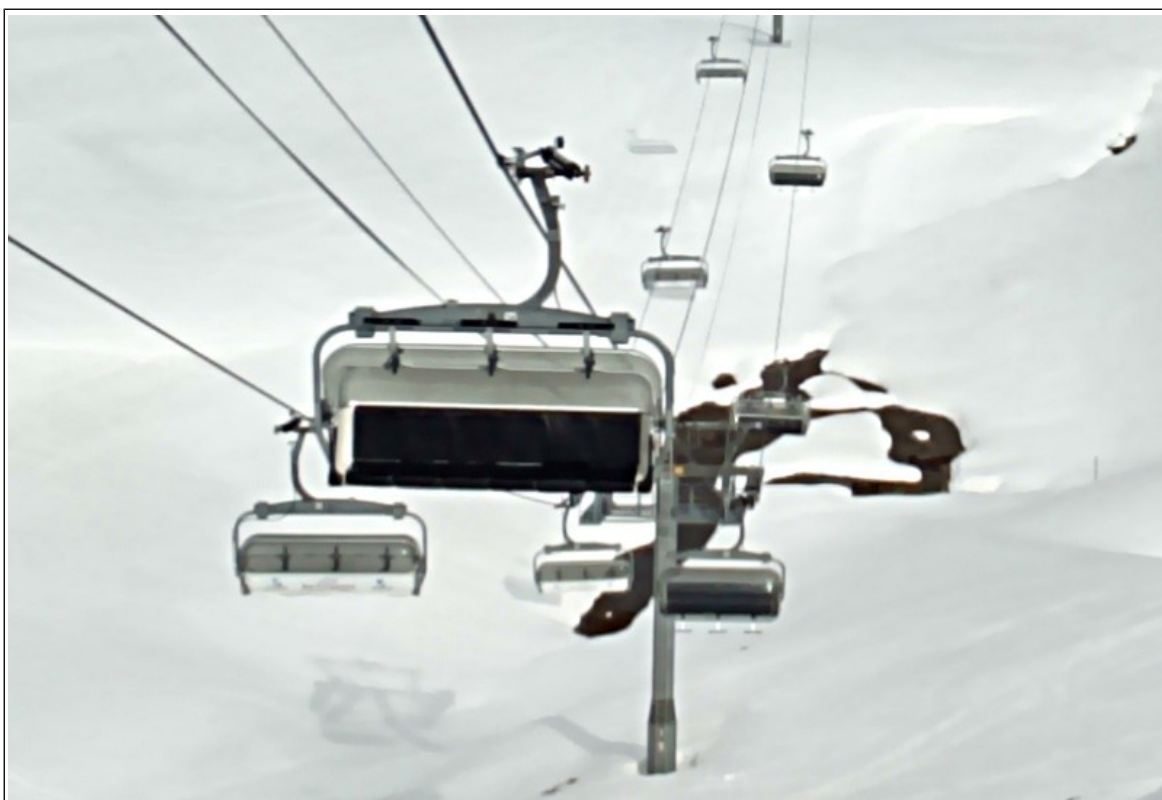
Figure 17 : Siège vide avec sa bulle ouverte
