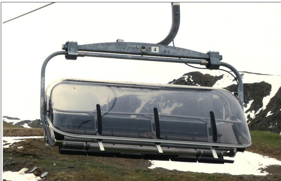
Figure 7 : Siège complet avec sa bulle de protection fermée
