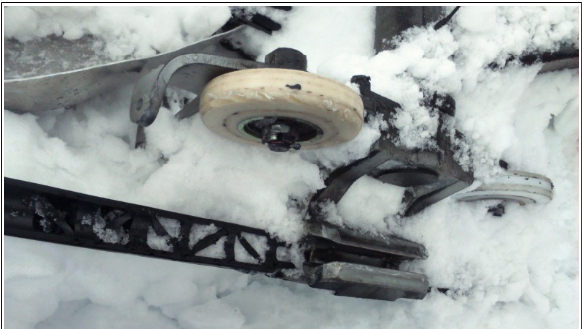
Figure 13 : Vue des dégâts superficiels de la pince
