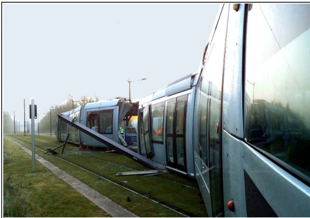
Figure 2 : la rame et le poteau support de caténaire après l'accident
