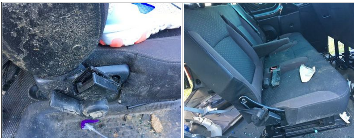
Figure 33 : Système de verrouillage extérieur de la ceinture de sécurité associée aux places à droite sur la 2 e et 3 e rangée (Source : rapport établi par l'expert judiciaire)
