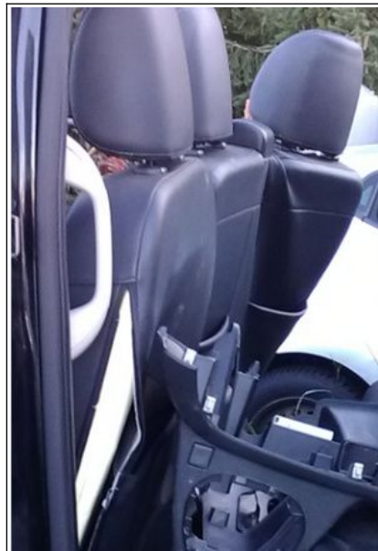
Figure 26 : Siège avant droit vrillé (Photo prise par le BEA-TT sur le lieu de remisage du véhicule)
