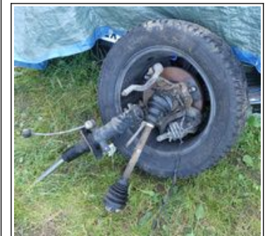
Figure 27 : Demi-train avant droit (Photo prise par le BEA-TT sur le lieu de remisage du véhicule)
