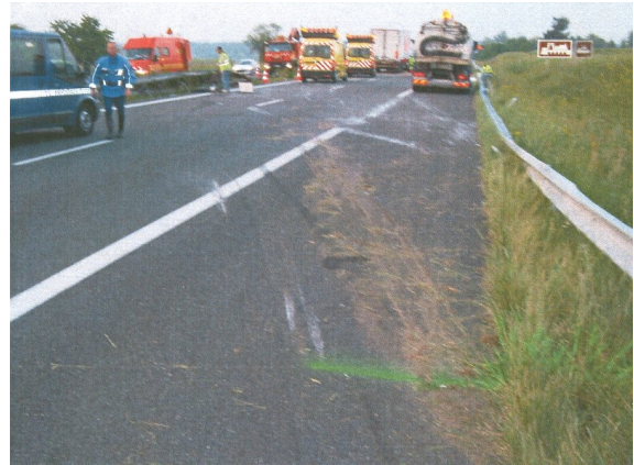
Les traces de ripage de l'ensemble routier (A+A') sur la chaussée, après renversement
