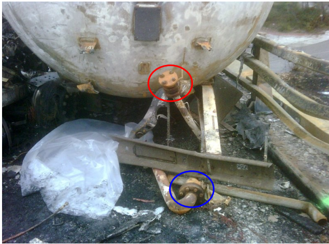
Figure 25 : Vanne de sortie de la phase liquide, dans le cercle bleu, et vanne de service de la phase gazeuse, dans le cercle rouge
