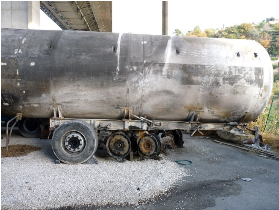
Fig 21 : Arrière de la citerne après l'accident, sans ses vannes et tuyauteries extérieures
