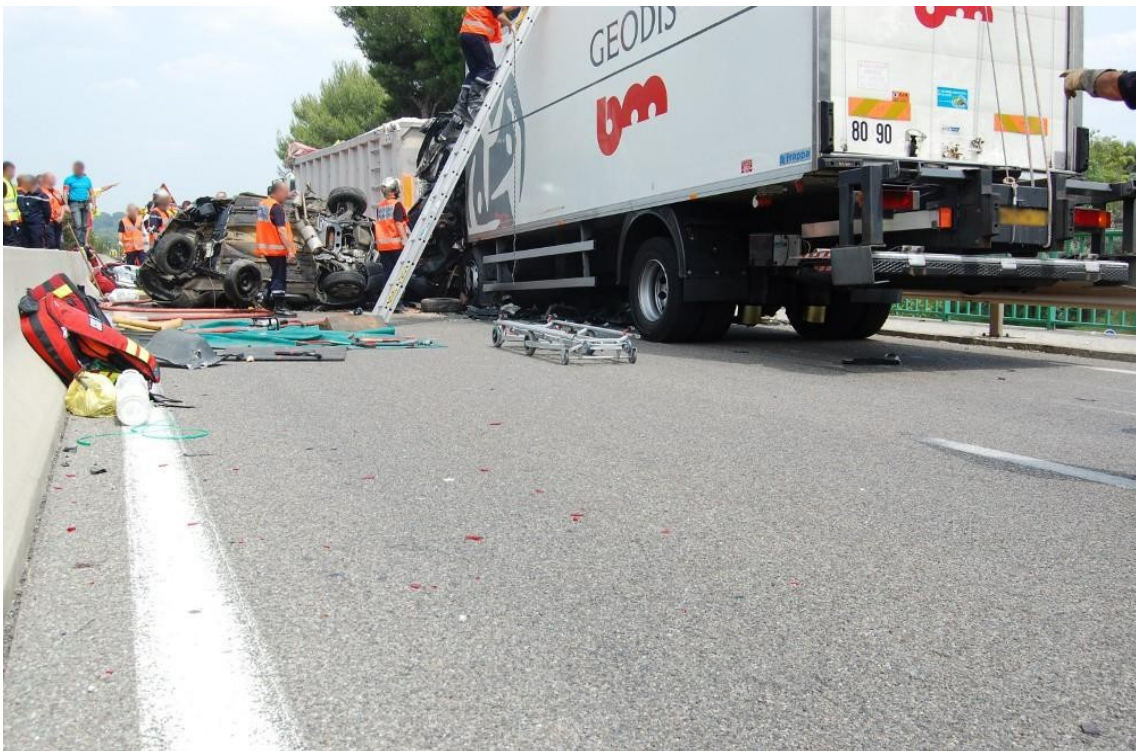
Photo 2 : sous la poussée des denrées, la caisse frigorifique a avancé de 60 cm sur le châssis
