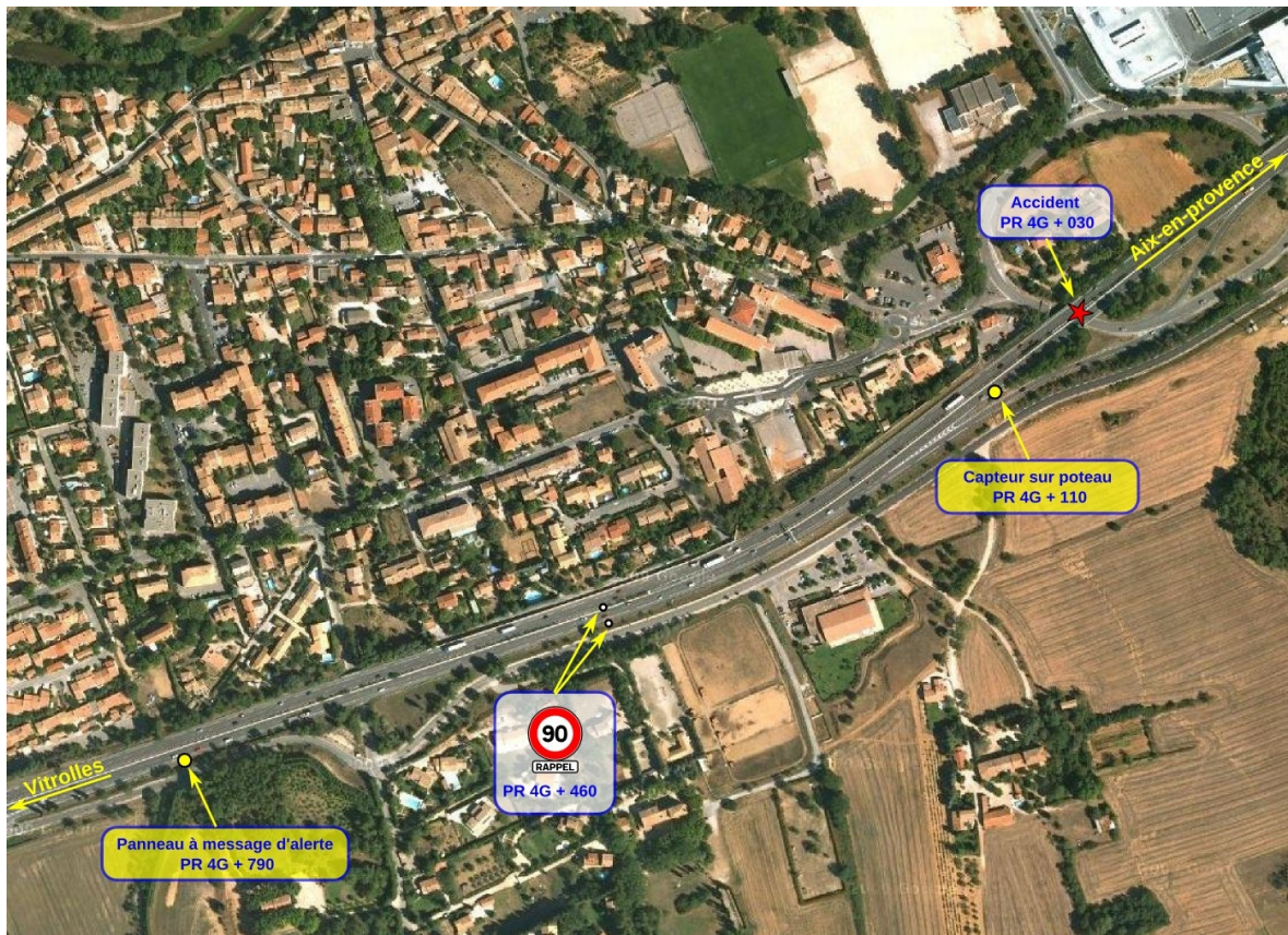
Figure 3 : position de la signalisation et des équipements de gestion du trafic
