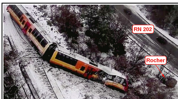
1 - La voiture de tête dans la pente, retenue par la seconde voiture restée sur la plate-forme
