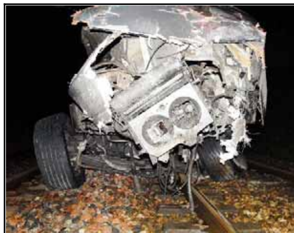
Figure 31 : Vue du train avant du tracteur routier coincé sous la motrice du TGV
