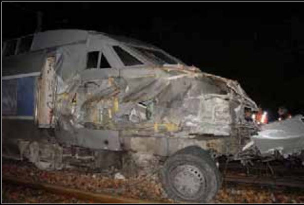
Figure 20 : Vue des dégâts occasionnés à la partie avant droite de la motrice du TGV. Un essieu de l'ensemble routier est encastré sous sa cabine de conduite.
