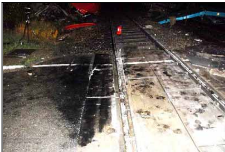
Figure 39 : Vue des traces d'huile moteur sur la chaussée
