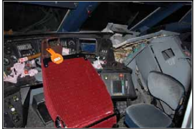
Figure 21 : Vue des dégâts provoqués à l'intérieur de la cabine de conduite du TGV accidenté
