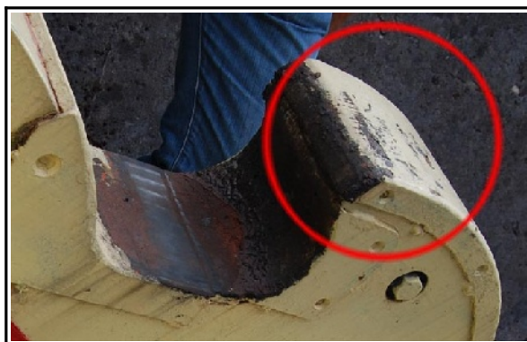
Figure 22 : Traces de chocs constatées sur le dessus des crochets aval
