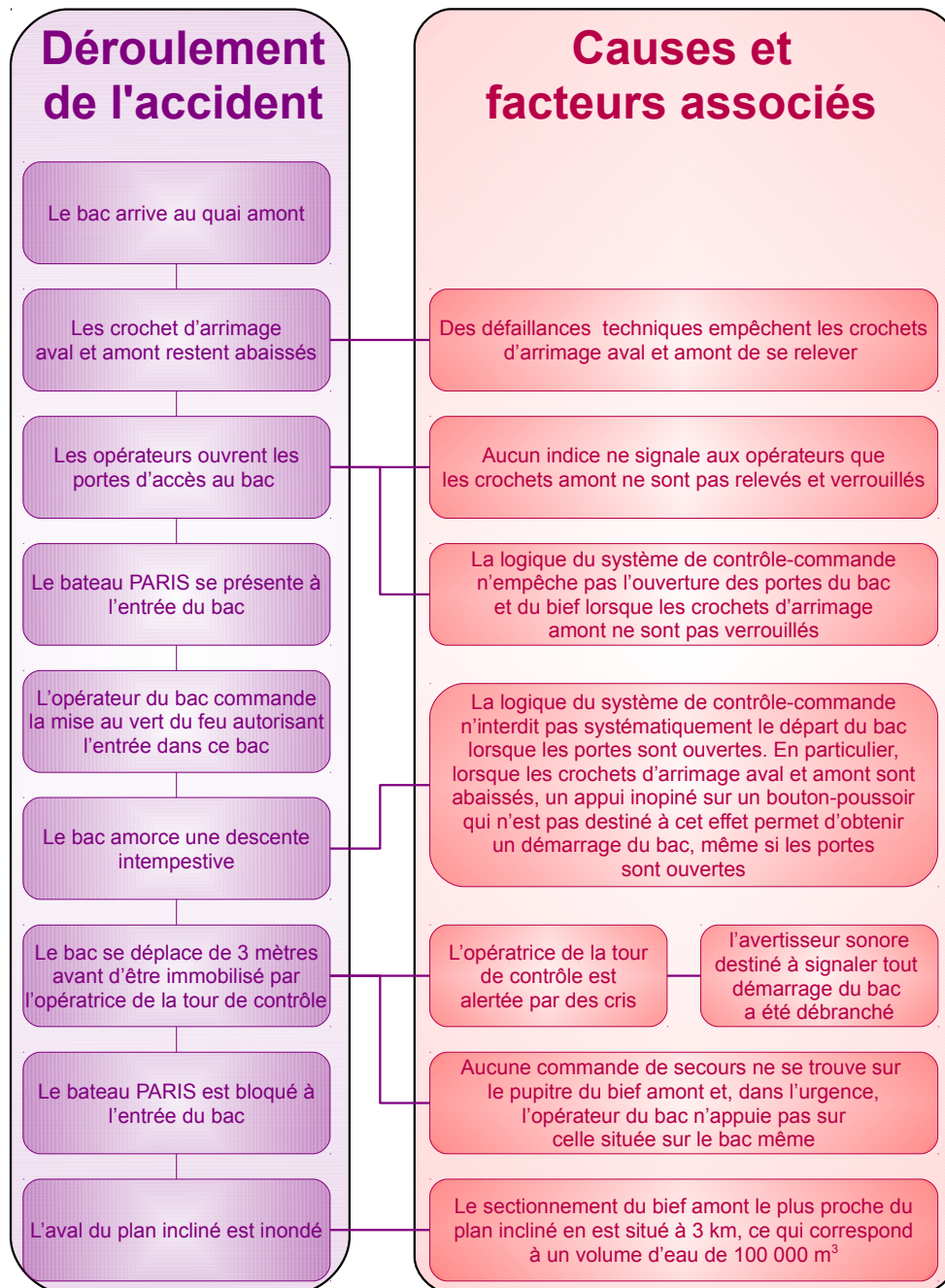
Figure 24 : Schéma des causes et des facteurs associés
