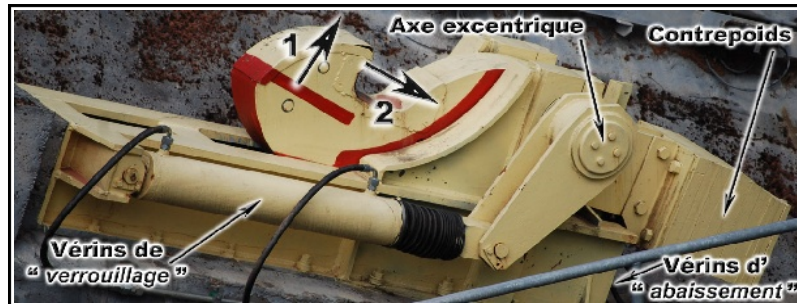
Figure 13 : Un des deux crochets aval dans la position relevée
