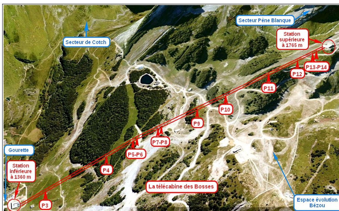
Fig. 3 : L'implantation de la télécabine des Bosses et de ses pylônes P3 à P14
