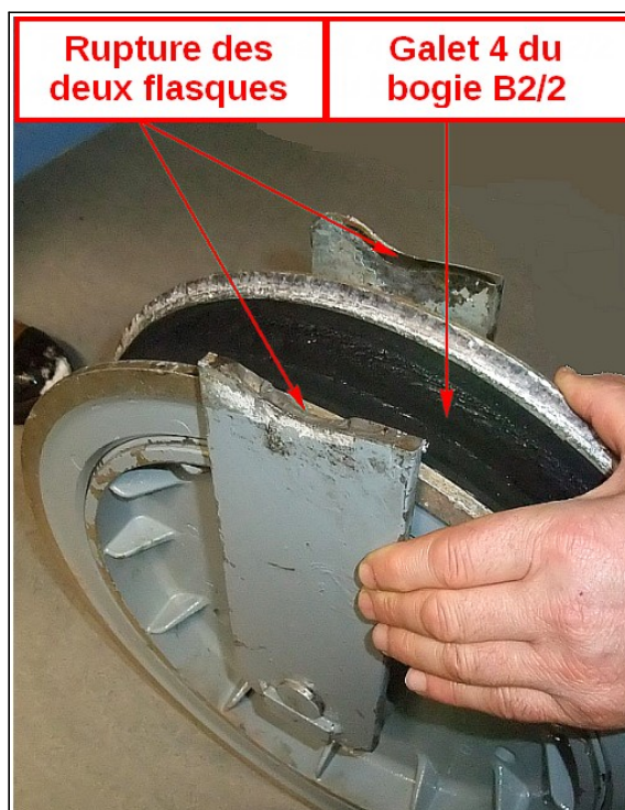
2 - La partie rompue du bogie B2/2 retrouvée au pied du pylône P14 avec le galet 4
