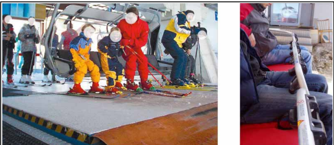
Tapis réduisant la hauteur entre l'assise des sièges et le sol et bavettes limitant l'espace entre le garde-corps et les jambes des skieurs
