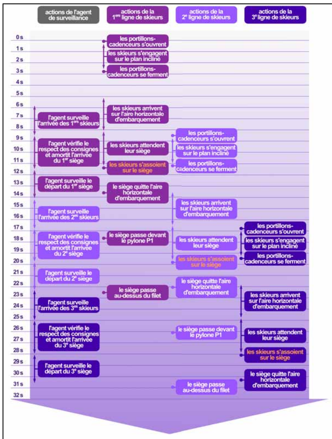
Fig. 14 : Reconstitution du déroulement de l'embarquement sur le télésiège « Fontaines-de-Cotch » de plusieurs lignes de skieurs successives
