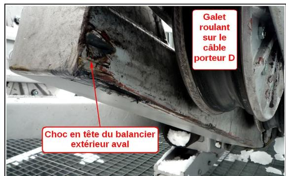
Fig. 11 : Les principaux dommages constatés sur les balanciers aval du chariot de la cabine 2
