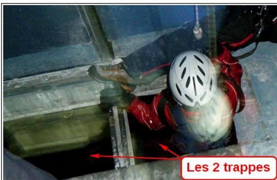
3 - L'évacuation verticale de la cabine 1 par les deux trappes aménagées dans le plancher
