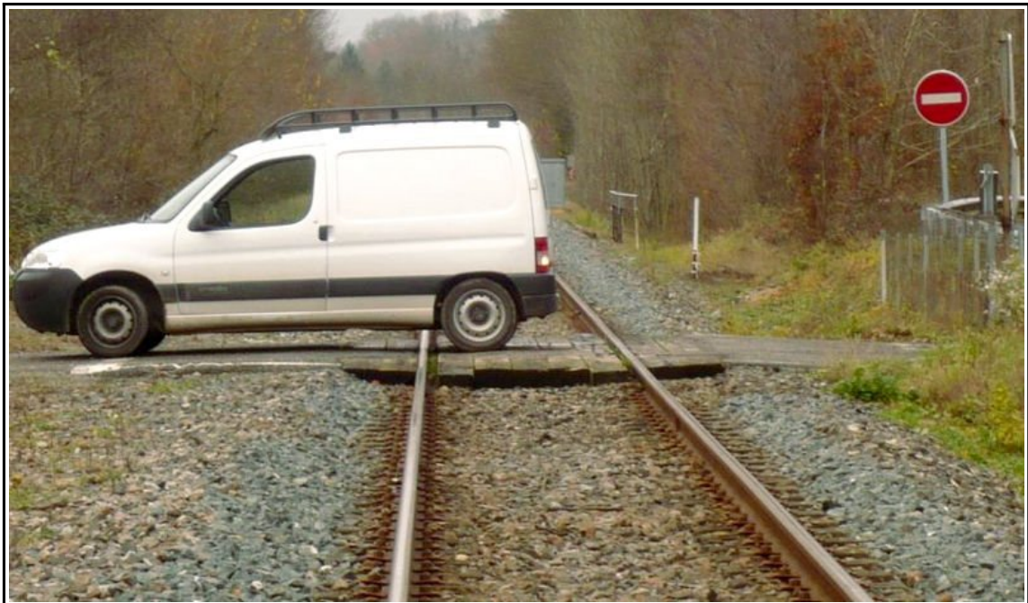
Figure 44 : Position d'une automobile de gabarit équivalent sur le passage à niveau lors du premier choc (vue prise dans le sens de circulation du train)
