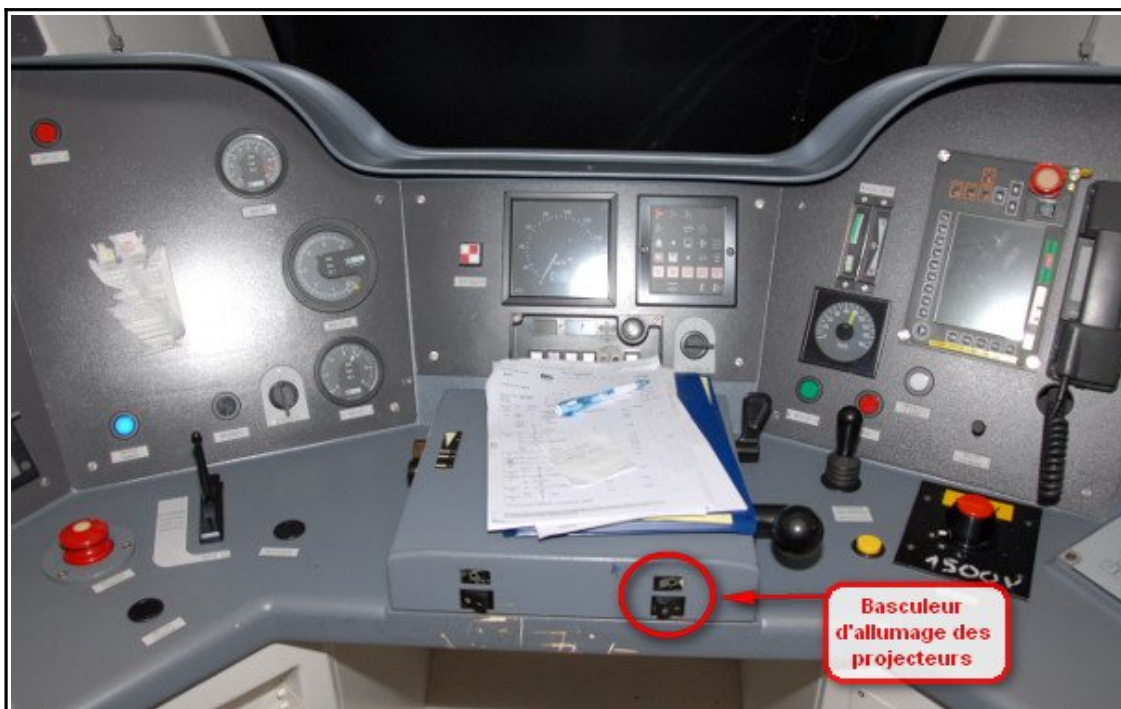
Figure 28 : Vue du tableau de bord de l'automotrice après l'accident
