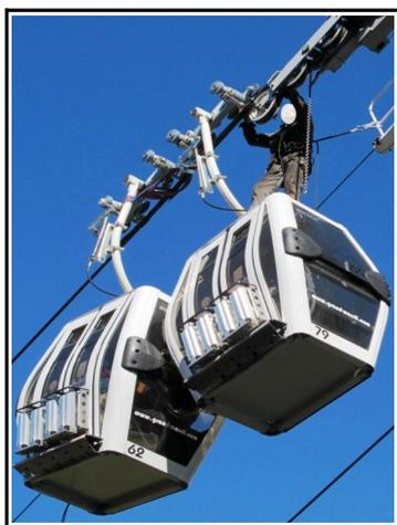
Fig. 35 : La mise en sécurité des cabines B' et C'
