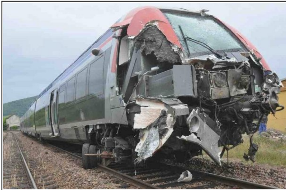
Figure 8 : L'avant du TER n° 893011 après l'accident
