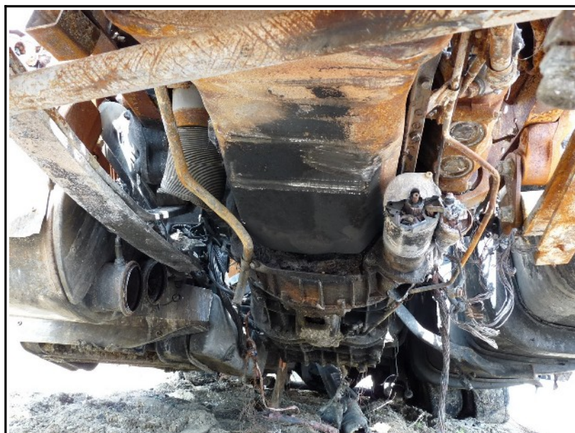
Figure 34 : Vue du soubassement du tracteur (A) épargné par les flammes
