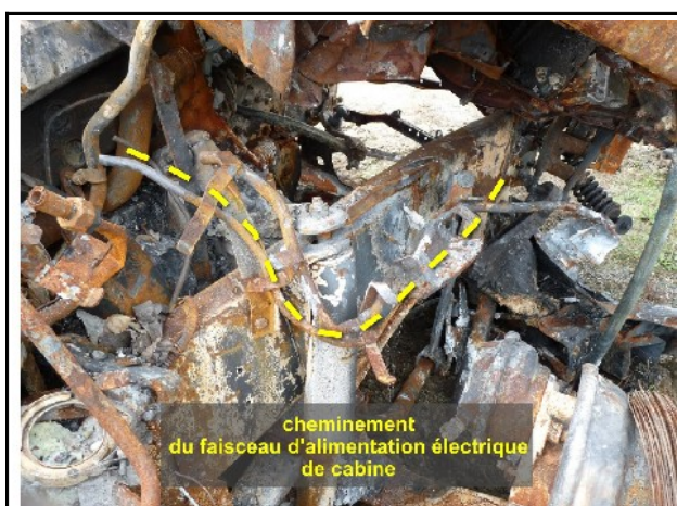
Figure 35 : Vue du côté avant droit du tracteur (A) visualisant le cheminement du faisceau électrique de cabine
