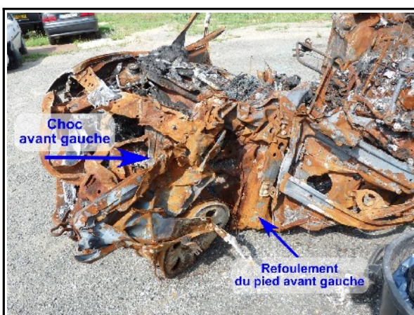
Figure 27 : Vue de la partie avant de la Dacia montrant l'importance des déformations subies
