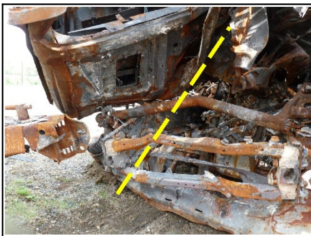
Figure 16 : Vue de la déformation linéaire sur la face avant du tracteur (A)
