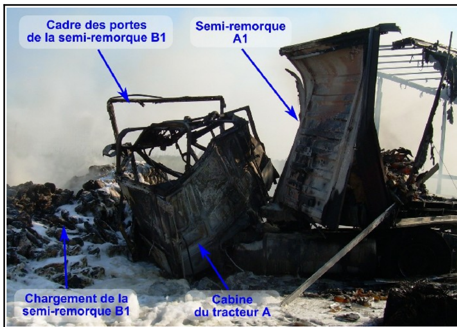
Figure 14 : Vue latérale gauche de l'ensemble routier (A+A1)
