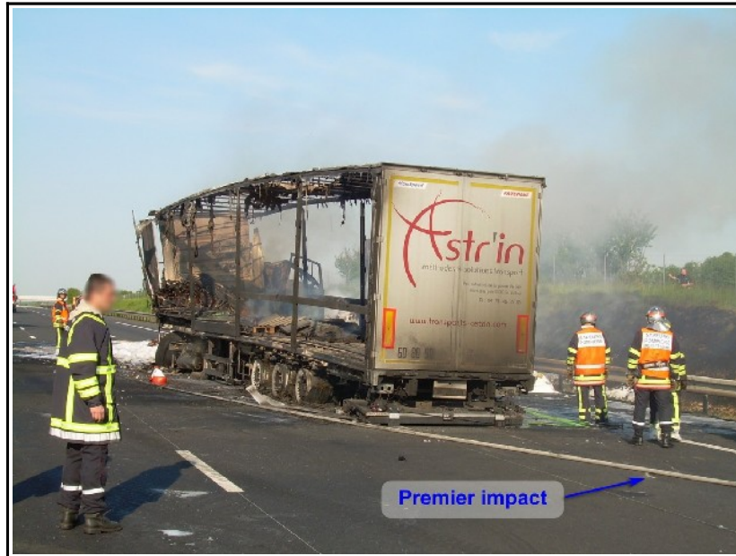
Figure 9 : Position des premières marques de sillons visibles sur la chaussée
