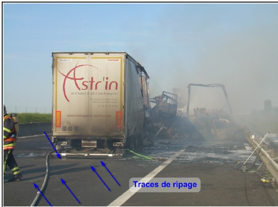
Figure 8 : Vue des sillons sur la chaussée
