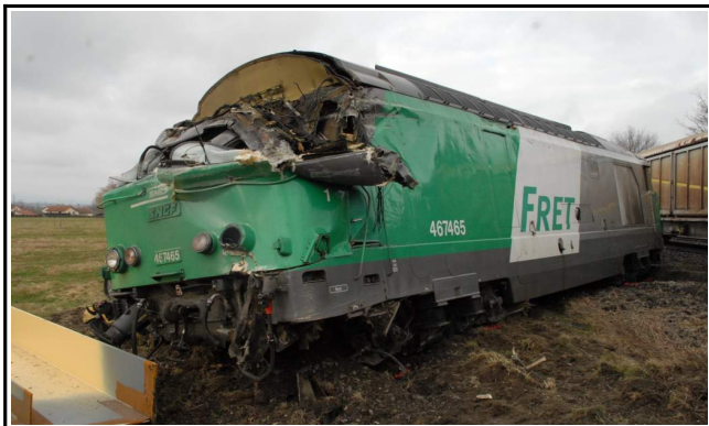
Figure 11 : Locomotive BB 467465 de tête, décapitée
