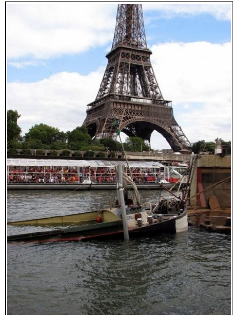
Figure 18 : La vidange des locaux avant de l'EOLE, puis la traction vers le dock flottant
