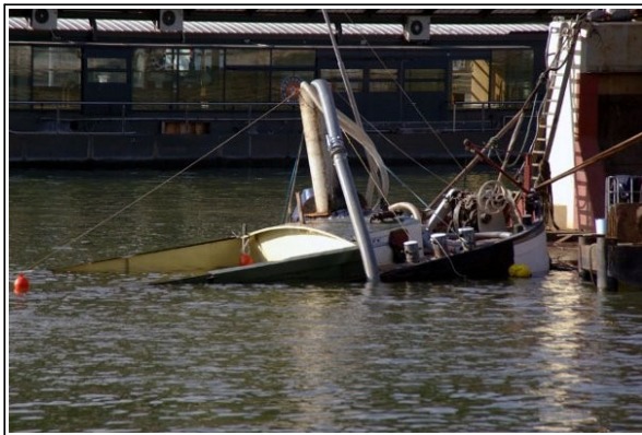
Figure 18 : La vidange des locaux avant de l'EOLE, puis la traction vers le dock flottant
