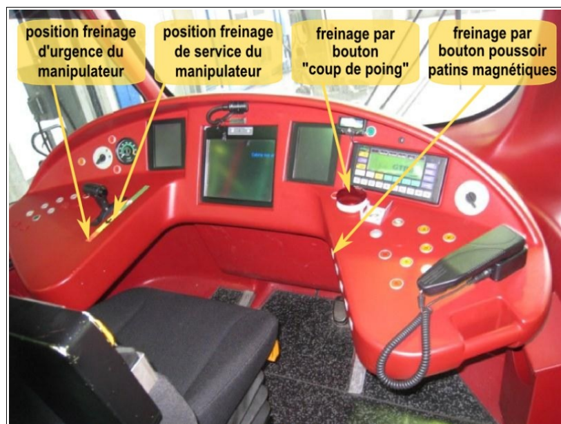
Fig. 8 : commandes de freinage à disposition du conducteur
