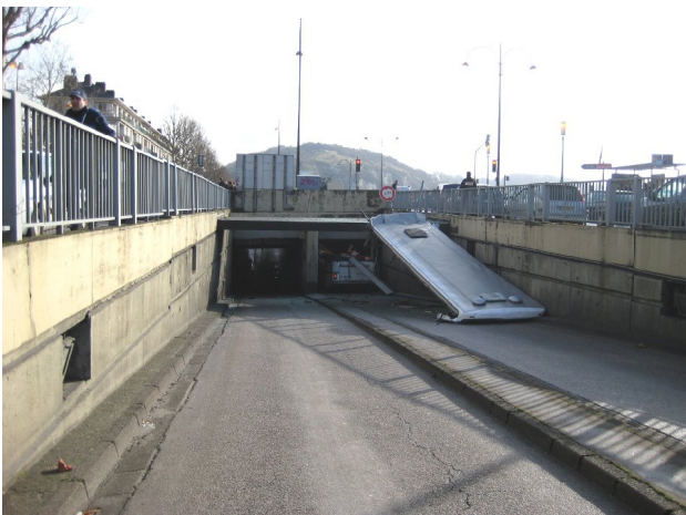
Le toit de l'autocar a été « découpé » par la partie supérieure de la trémie
