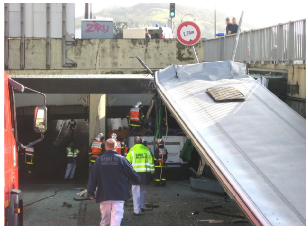
Le toit de l'autocar a été « découpé » par la partie supérieure de la trémie
