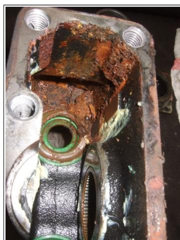
Fig 16 : chambre de l'étrier du frein droit du module MI2
