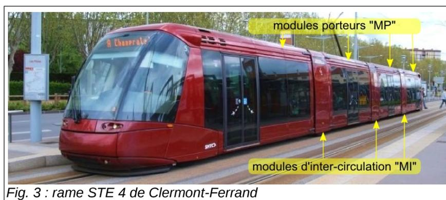
Fig. 3 : rame STE 4 de Clermont-Ferrand
