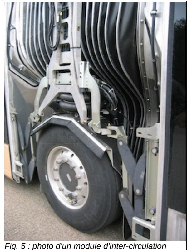
Fig. 5 : photo d'un module d'inter-circulation
