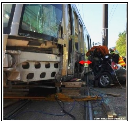
Fig 27 : Opérations d'écartement de la rame
