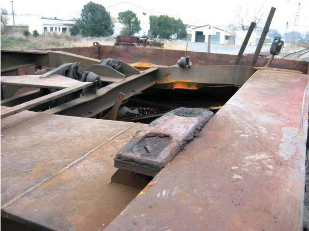
*Figure 8 : Vue d'un lisoir de bogie peu usé (en position 5-7)*
