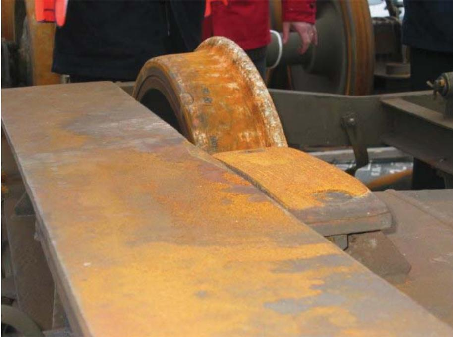
*Figure 7 : Vue du lisoir de bogie le plus usé (en position 2-4)*
