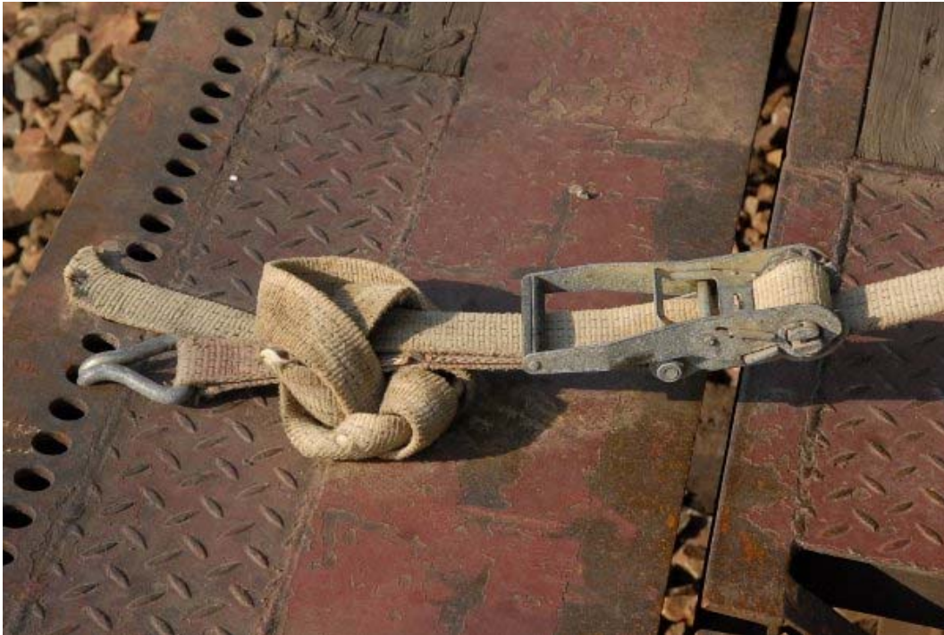
Sangle très usagée retrouvée sur le deuxième wagon, peu touché par l'accident
