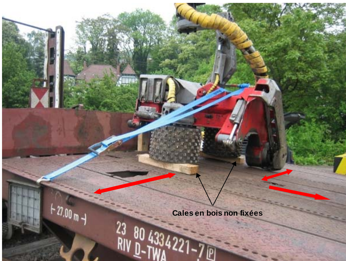
Figure17 : Tête d'abattage non fixée au plancher du wagon En rouge , les mouvements transversaux et longitudinaux possibles
