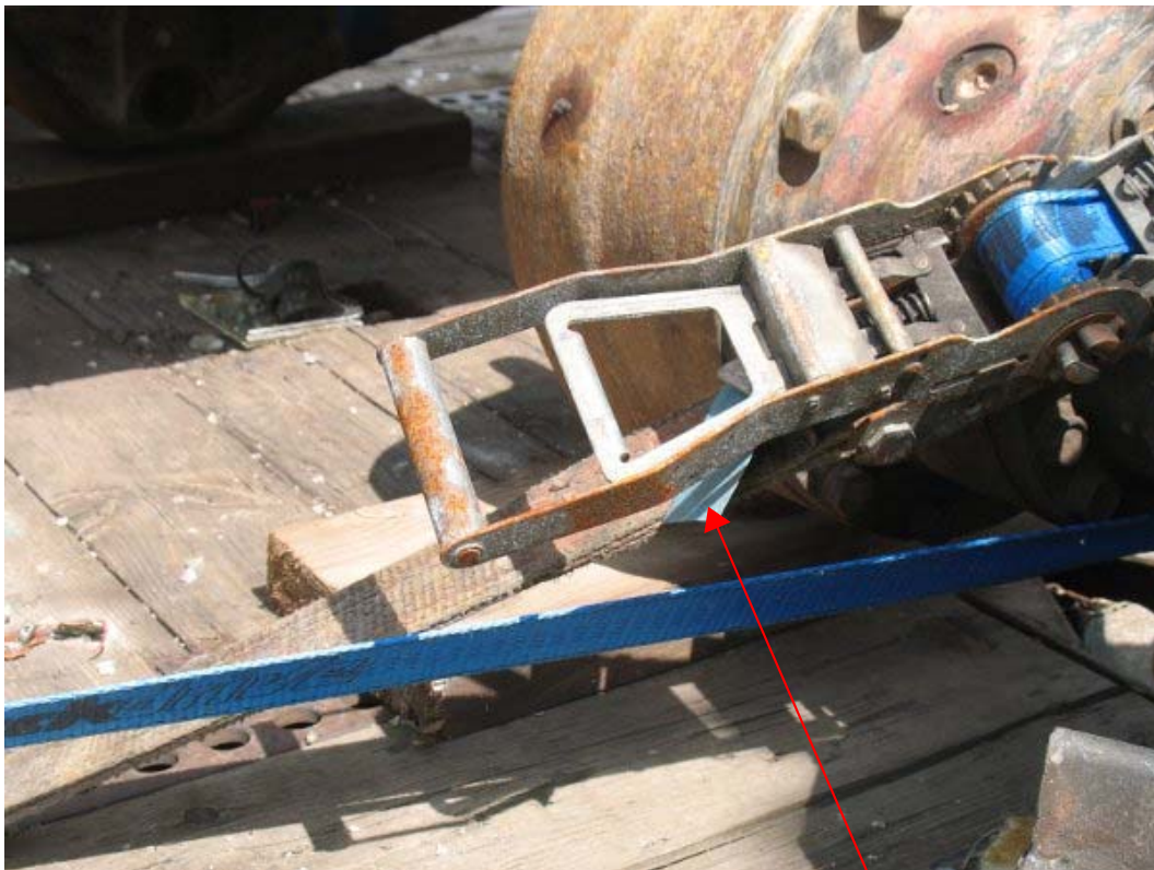
Sangle retrouvée sur le premier wagon avec une étiquette de validité effacée
