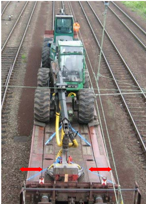
Figure 19 : Engin forestier Skogsjan chargé en biais de 10 à 15° sur wagon TWA 800 sans immobilisation de la tourelle avec arrimage (sangles de 2 500 daN) et calage inadaptés
