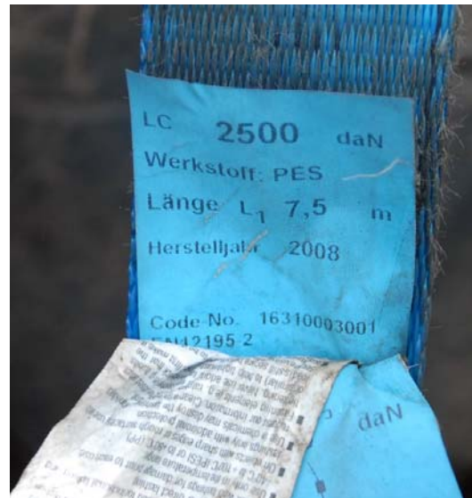
Figure 20 : Sangle de 2 500 daN retrouvée sur le chargement
