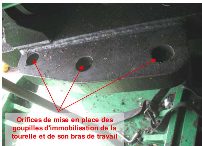
Figure 16 : Orifices d'immobilisation du Skogsjan 487XL
