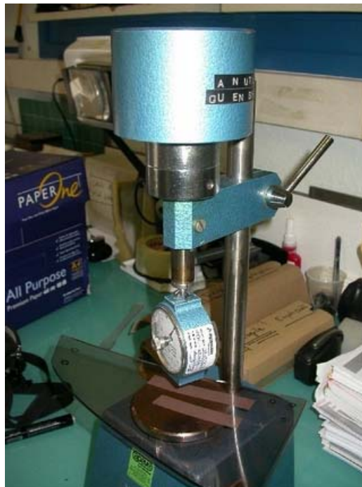
Photo 12 : Mesure de la dureté avec le « Duromètre Shore » d'un morceau du vitrage de la cabine accidentée
