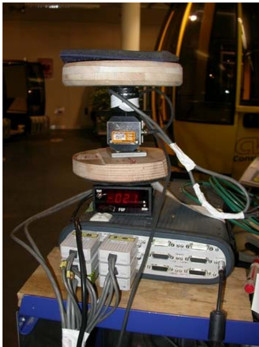
Photo 16 : Matériel de mesure des efforts dynamiques
