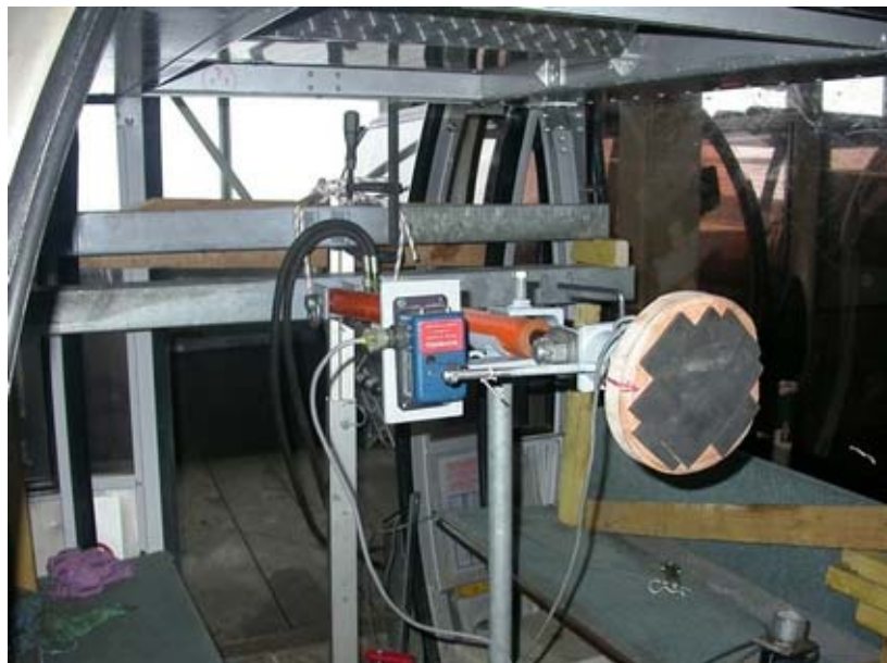
Photo 15 : Mesure de l'effort statique au déboîtement de type « A » sur cabine « Piccolo »
