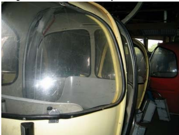
Photo 3 : Vitrage déboîté et maintenu en place sur un « œuf 4 places »
