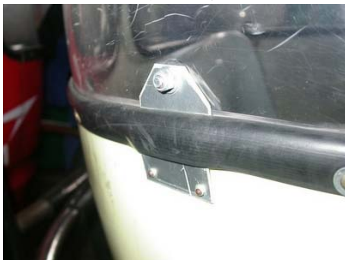
Photo 2 : Vitrage maintenu par pattes de fixation sur un « œuf 4 places » (on aperçoit des rivets de maintien du joint, de part et d'autre de la patte de fixation)
