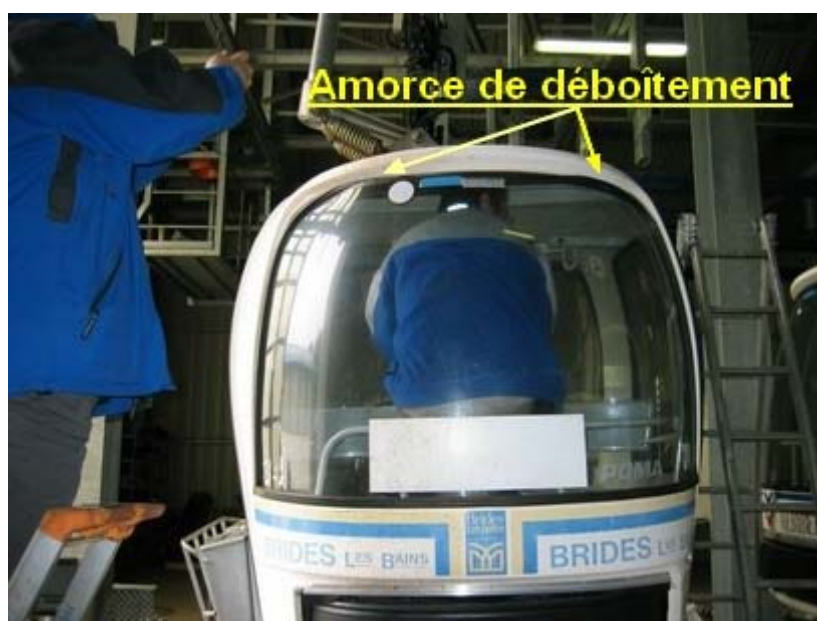
Photo 4 : Déboîtement du vitrage d'une cabine « œuf 6 places dos à dos » par pression du dos, en assise sur les barres de maintien, par détournement d'usage
