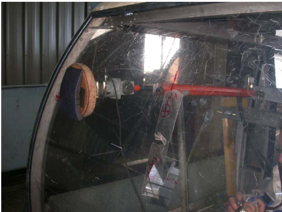
Photo 18 : Mesure de l'effort statique au déboîtement de type « C » sur cabine « Piccolo »
