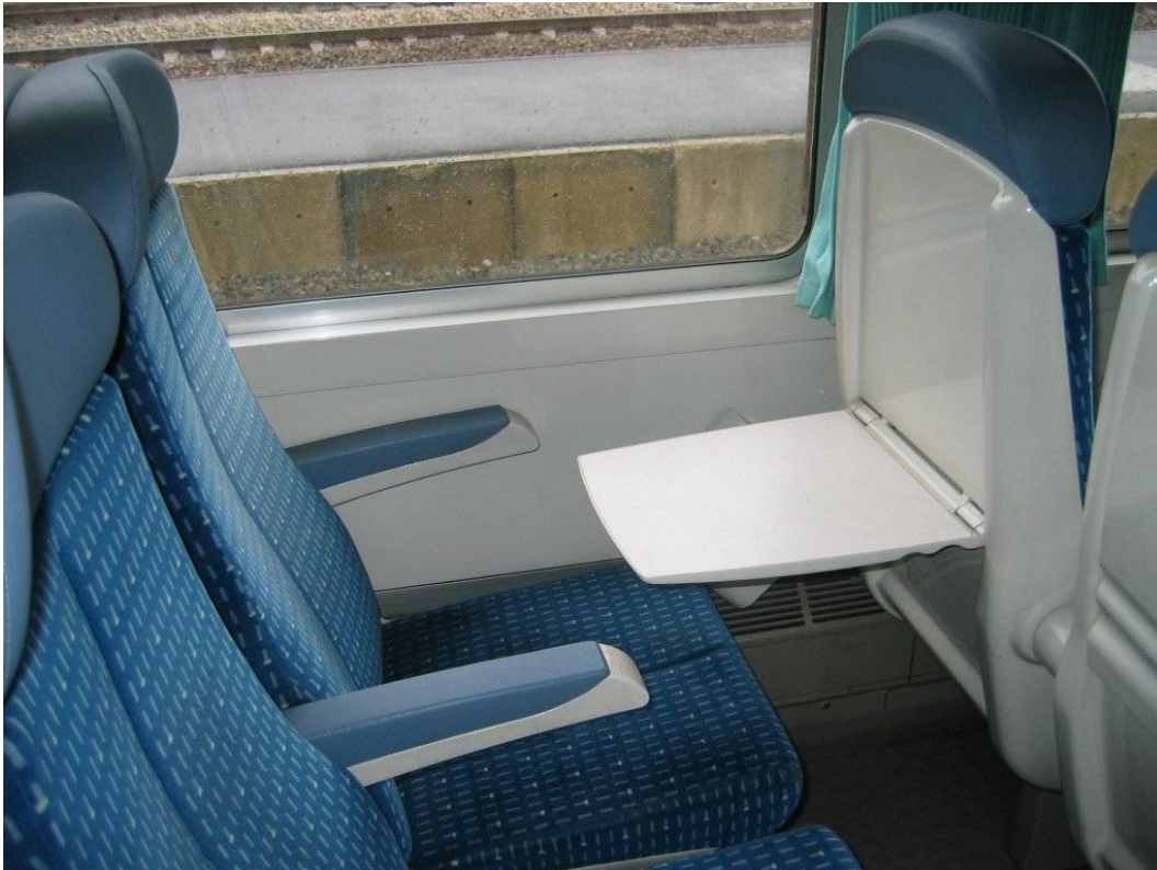
Photo 3 : Les dos de siège, recouverts de plastique dur, et tablettes du train contre lesquels des passagers se sont blessés.
