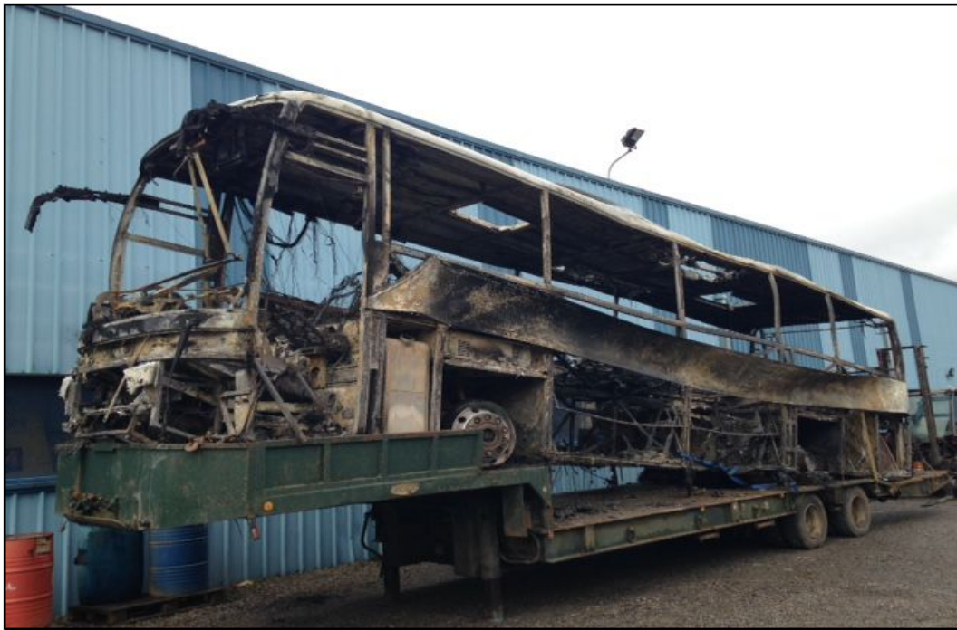
Figure 17 : Vue de l'autocar incendié (côté gauche) (CAR1)
