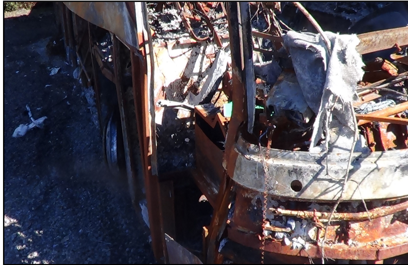
Figure 19 : Déformation avant droite de l'autocar (CAR1)
