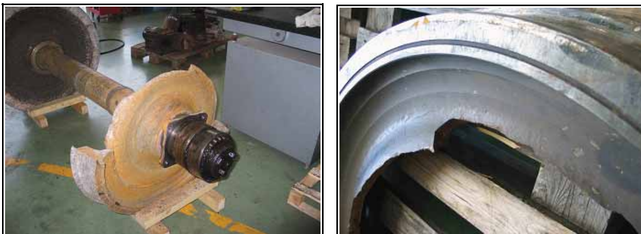
Figure 9 : Vues de l'essieu et du morceau de la roue détaché
