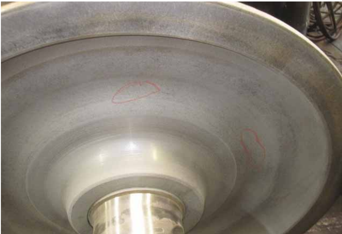
Figure 21 : Roue nettoyée avec deux fissures, non détectables visuellement
