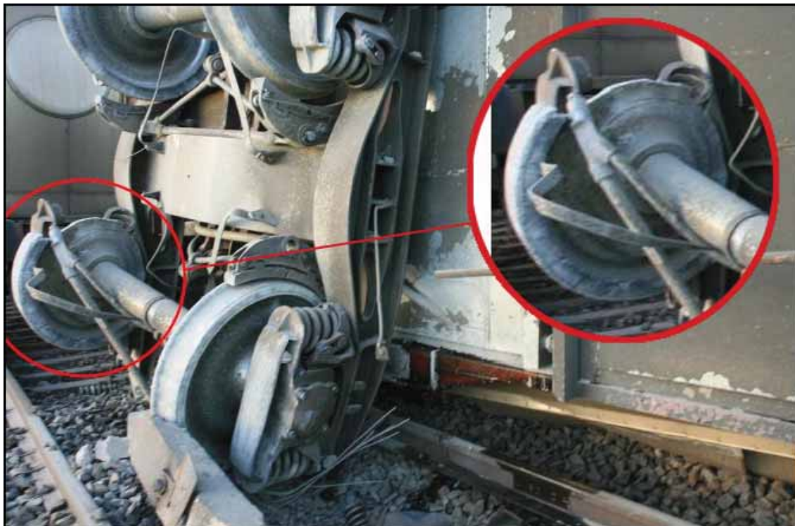
Figure 2 : Vue du wagon n° 33 87 792 9543-9 et de sa roue cassée
