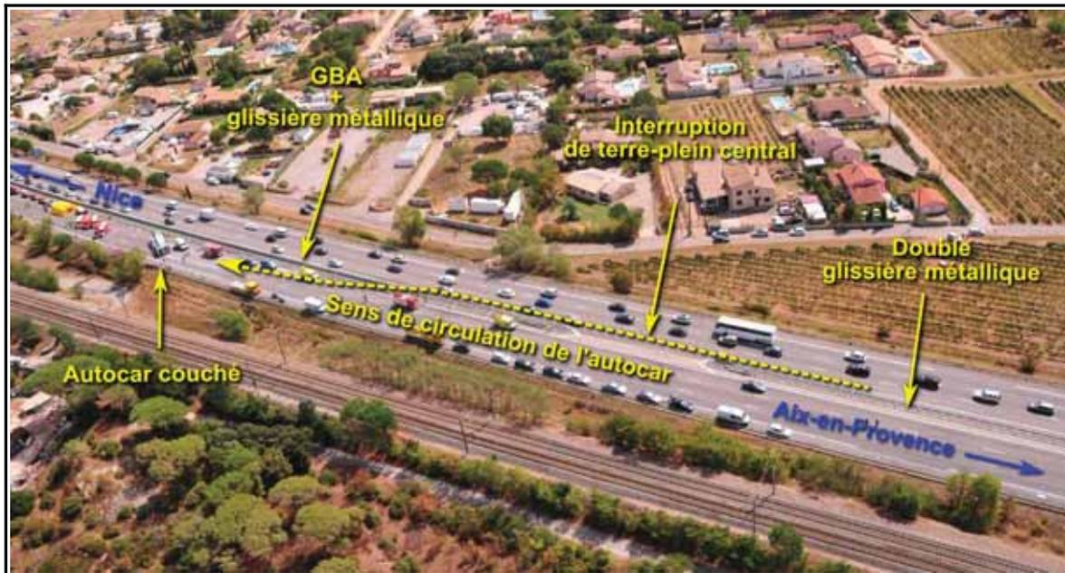
*Figure 2 : Vue des séparateurs équipant le terre-plein central au niveau de la zone de l'accident*
