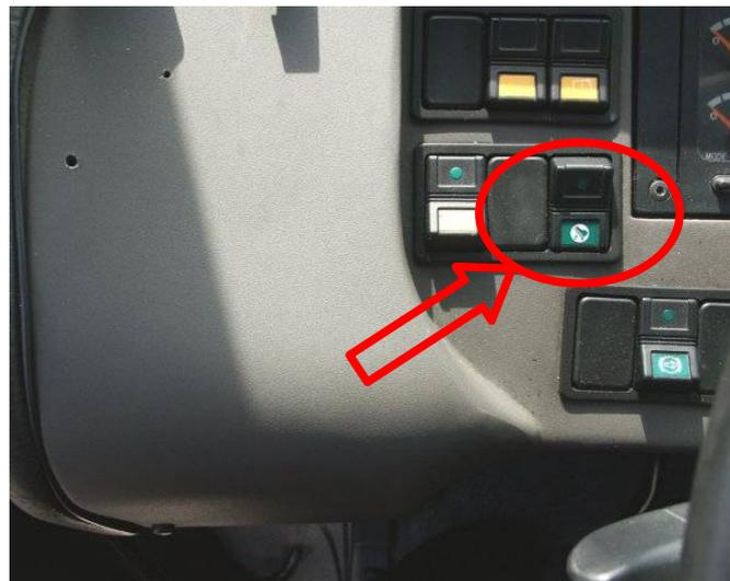
**Fig.10 : Interrupteur de commande du ralentisseur hydraulique également par la pédale de frein**
