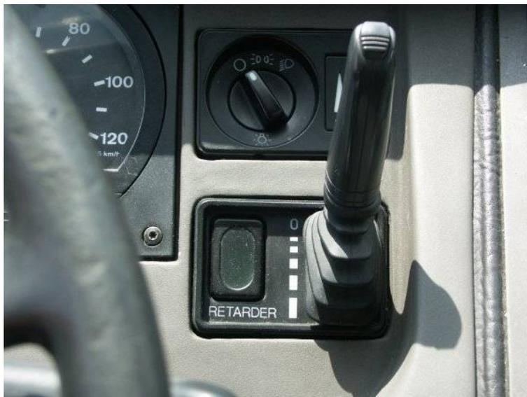
**Fig.9 : Levier de commande du ralentisseur hydraulique**
