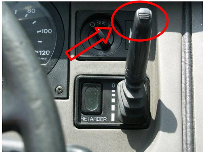
**Fig.11 : Interrupteur de régulateur de vitesse en descente**
